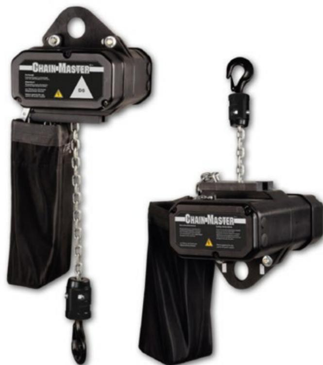
CHAIN MASTER BGV-D8 — одноцепная электрическая лебёдка с прямым управлением и стационарно-самоподъёмным режимом работы, предназначенная для вертикального перемещения грузов. Цепь с вертлюжным крюком, фрикционная муфта защиты от перегрузок, 5-гнездовой шкив протяжки цепи, подвеска с проушиной, 1 электромагнитный тормоз DC. Коэффициент запаса 5.
