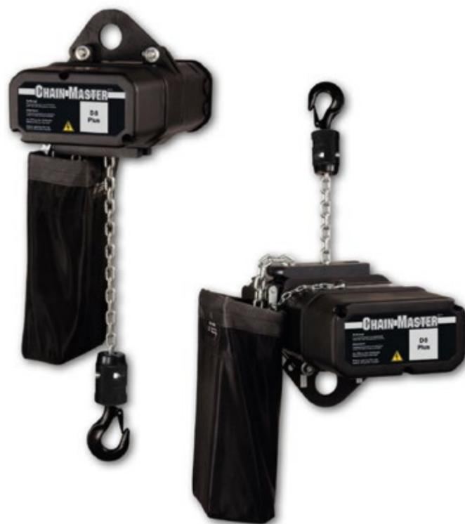
CHAIN MASTER BGV-D8Plus — одноцепная электрическая лебёдка с прямым управлением и стационарно-самоподъёмным режимом работы, предназначенная для вертикального перемещения грузов. Цепь с вертлюжным крюком, фрикционная муфта защиты от перегрузок, 5-гнездовой шкив протяжки цепи, подвеска с проушиной, 2 электромагнитных тормоза DC. Коэффициент запаса 10.
